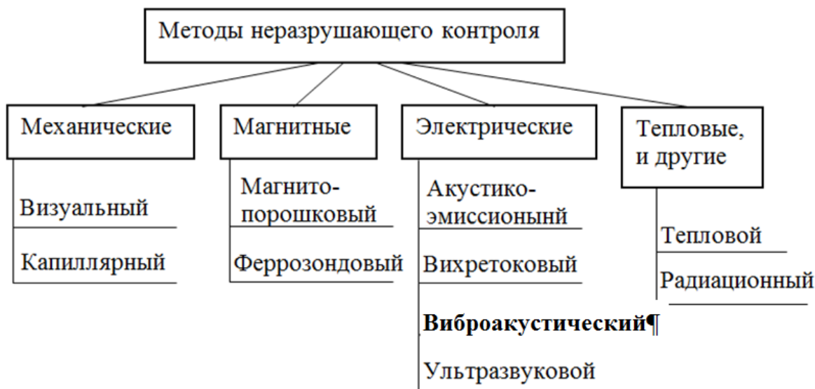
Рисунок 1.5- Классификация методов неразрушающего контроля
