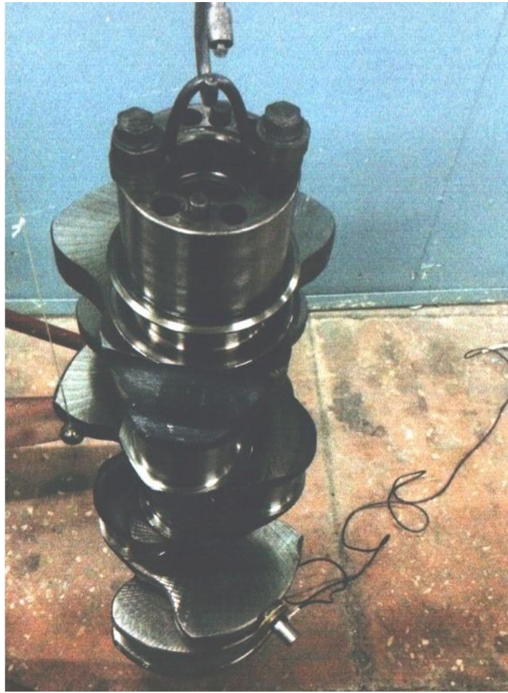
Рисунок 3.3 - Схема действия бойка и крепления датчика в экспериментальной установке
