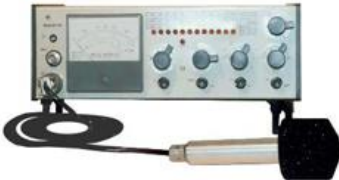
Рисунок 3.2 - Измеритель шума и вибраций ВШВ-003-М3
